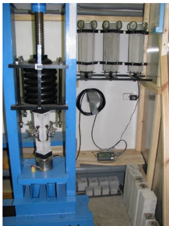
Рис. 2. Длительные испытания. Контроль нагрузки динамометром
