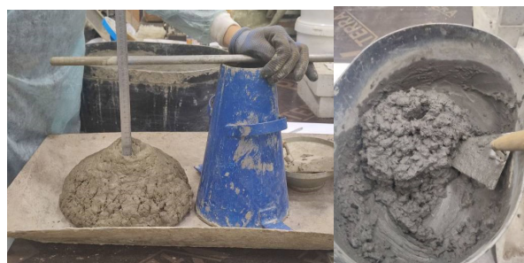
Рис.1 Определение подвижности бетонной смеси
