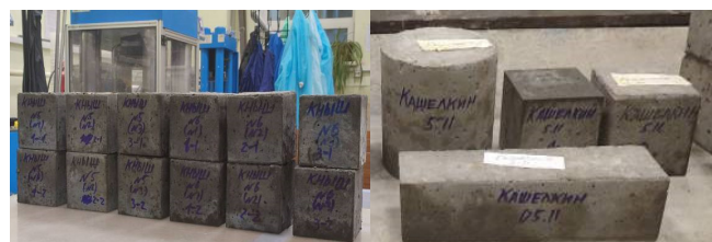
Рис. 2 Образцы кубы, призмы и цилиндры для определения свойств
