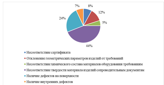
Рисунок 2 – Причины отбраковки компонентов нефтегазового трубопровода (источник: составлено авторами)
