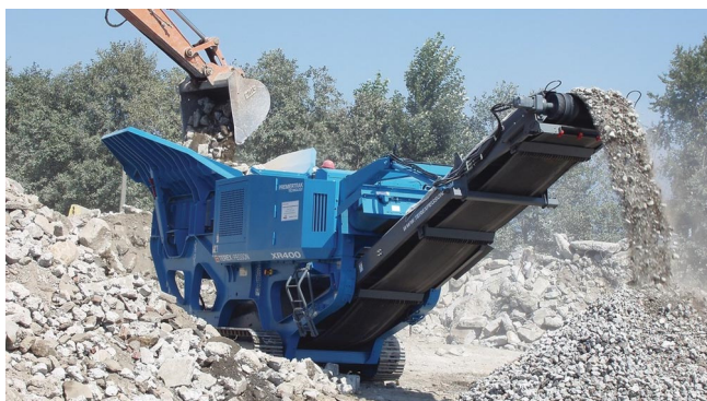
Рисунок 7. Мобильная щековая дробилка железобетонного боя. Источник: https://ex-beton.ru/stati/drobilki-dlya-betona-i-zhelezobetona
