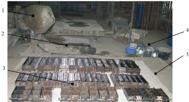
Рис. 1. Общий вид рабочего места по изготовлению образцов: 1 – гравитационный смеситель; 2 – поддон; 3 – стальные формы для изготовления бетонных и железобетонных образцов; 4 – исходные материалы; 5 – виброплощадка
