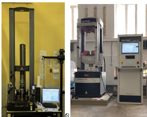
Рисунок 2 - а) универсальная электромеханическая машина Instron-5969 б) сервогидравлическая испытательная машина с компьютерным управлением WERES U-600
